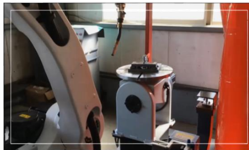
定位器框架銲接
